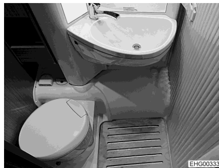
Bild 164 Toilettstol, vriden mot väggen
