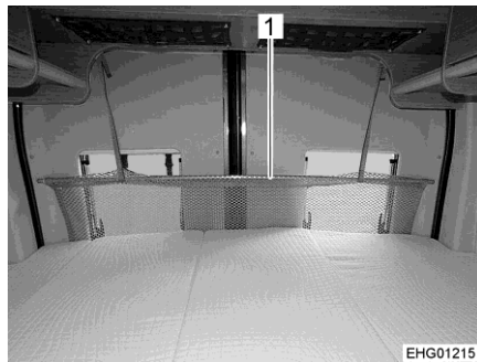
Bild 58 Fallskydd (längsgående bakre säng)
