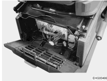
Bild 82 Monteringsställe el-block (Stellantis)
