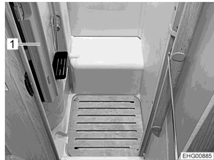
Bilde 169 Stor svingarmvegg, dreid
