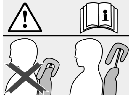
Bilde 26 Korrekt justering av nakkestøttene
