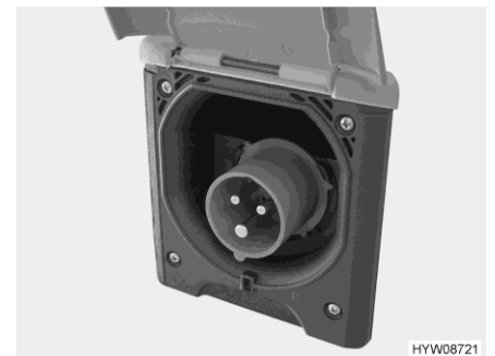
Bilde 117 230 V-tilkobling til kjøretøyet (CEE-stikkontakt)
