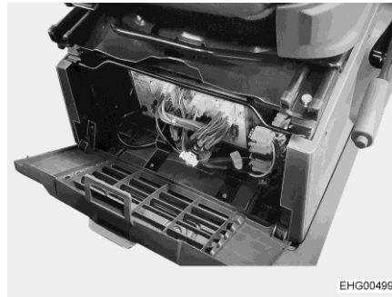
Bilde 112 Monteringssted for strømsentralen (Stellantis)
