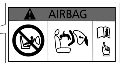
Bilde 14 Advarsel barnesikringssystem (solskjerm for passasjer)
