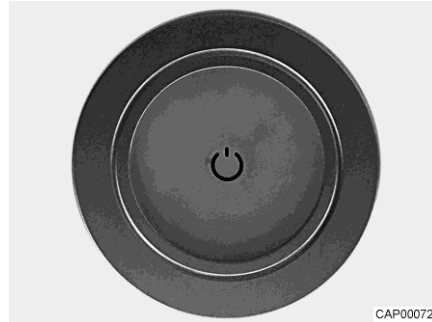
Bilde 76 LED-lampe med berøringsbetjening
