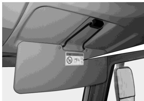
Bilde 14 Advarsel barnesikringssystem (solskjerm for passasjer)
