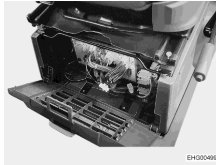
Bilde 82 Monteringssted for strømsentralen (Stellantis)
