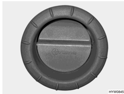
Bilde 101 Luftdyse (varmlufts-varmeanlegg)
