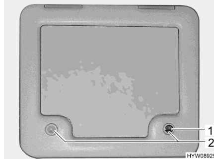
Bilde 131 Klaff for kloakktanken
