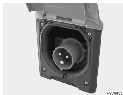
Fig. 117 Collegamento a 230 V al veicolo (presa CEE)
