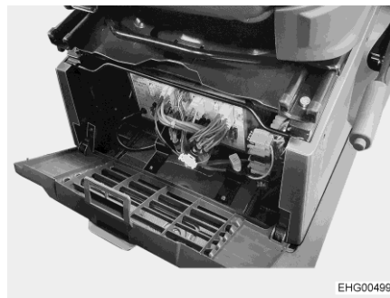
Fig. 112 Ubicazione centralina elettrica (Stellantis)
