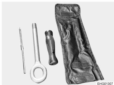
Fig. 141 Occhione di traino e cacciavite (veicolo di base Stellantis)
