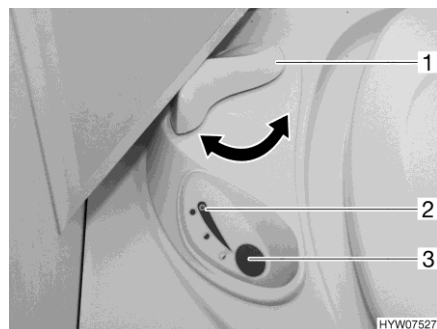
Fig. 130 Centralina di controllo toilette Thetford
