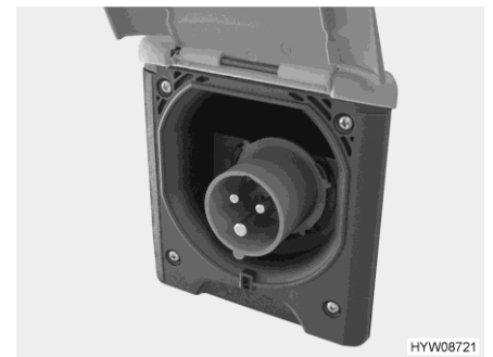
Fig. 87 Collegamento a 230 V al veicolo (presa CEE)
