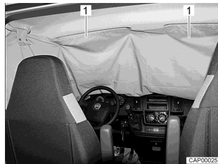
Fig. 27 Oscurante per cabina di guida sul parabrezza
