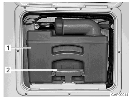
Fig. 174 Réservoir pour matières fécales
