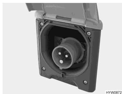
Fig. 117 Raccordement 230 V sur le véhicule (prise de courant CEE)
