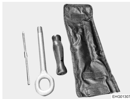
Fig. 184 Œillet de remorquage et tournevis (véhicule porteur Stellantis)
