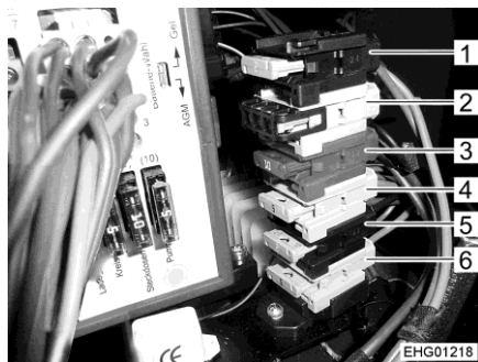
Fig. 126 Fusibles à côté du bloc électrique (Ford)
