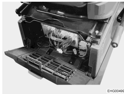
Fig. 82 Emplacement bloc électrique (Stellantis)
