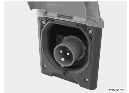
Fig. 87 Raccordement 230 V sur le véhicule (prise de courant CEE)
