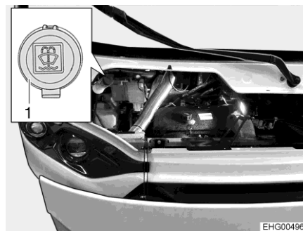
Kuva 13 Täyttöaukko (ikkunanpesu- vesi)
