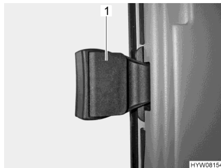
Kuva 46 Liukuikkuna ilman lukitusta
