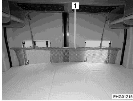
Kuva 58 Putoamissuoja (pitkittäiset takasängyt)
