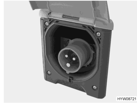
Kuva 87 230 V:n liitäntä ajoneuvolla (CEE-pistorasia)
