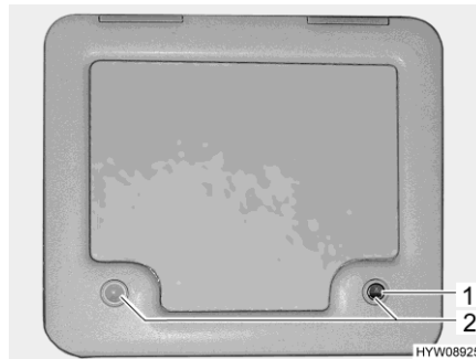
Fig. 173 Trampilla para el depósito de aguas fecales
