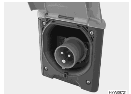
Fig. 117 Conexión de 230 V en el vehículo (caja de enchufe CEE)
