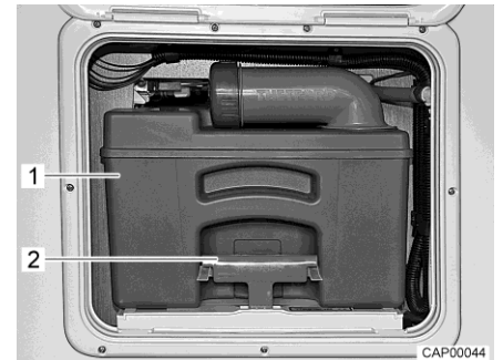
Fig. 174 Depósito de aguas fecales
