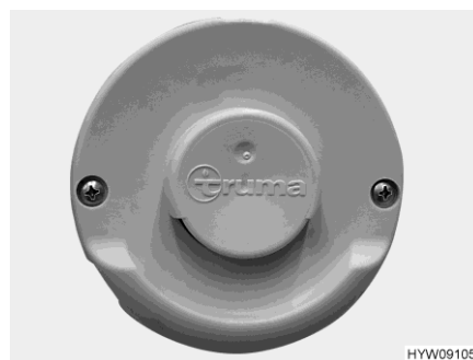
Fig. 141 Tubo de chimenea en la pared (calefacción de aire caliente)
