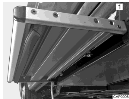
Fig. 135 End stop (entrance step)
