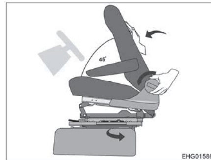
Bild 24 Rückenlehne nach vorn kippen
