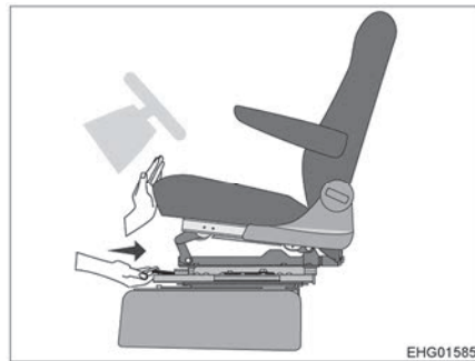
Bild 23 Sitz nach hinten schieben
