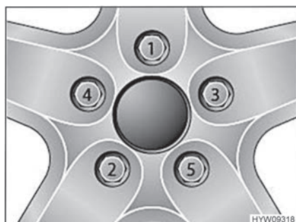
Bild 143 Radmuttern oder Radschrauben über Kreuz festziehen
