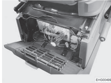
Bild 82 Einbauort Elektroblock (Stellantis)
