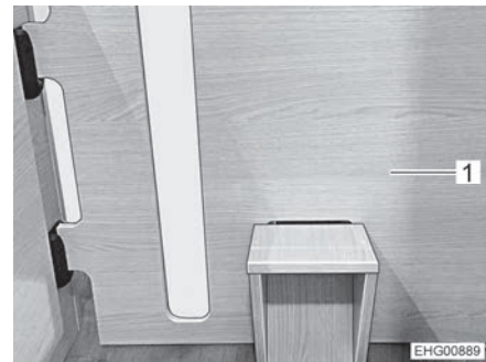
Bild 51 Zwischenwand mit Tritt-Element
