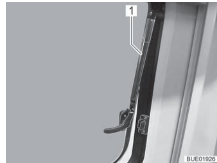
Bild 22 Ausstellfenster mit Automatik-Ausstellern, geöffnet
